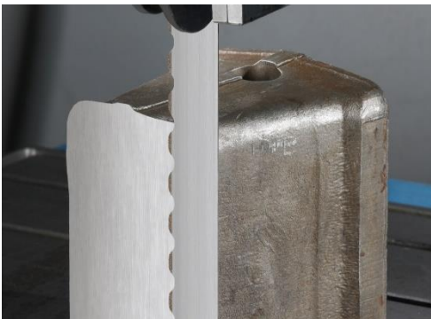
Figura 3: CUBOGRIT® U, la cinta de sierra recubierta de CBN para piezas de trabajo de grandes dimensiones.
