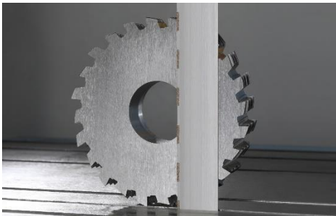
Figura 2: CUBOGRIT® S, la cinta de sierra segmentada, recubierta de CBN, para piezas de trabajo de tamaño medio.
