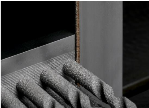
Abbildung 1: CUBOGRIT® K, das kontinuierliche CBN-bestreute Sägeband für kleine Werkstückdimensionen.
