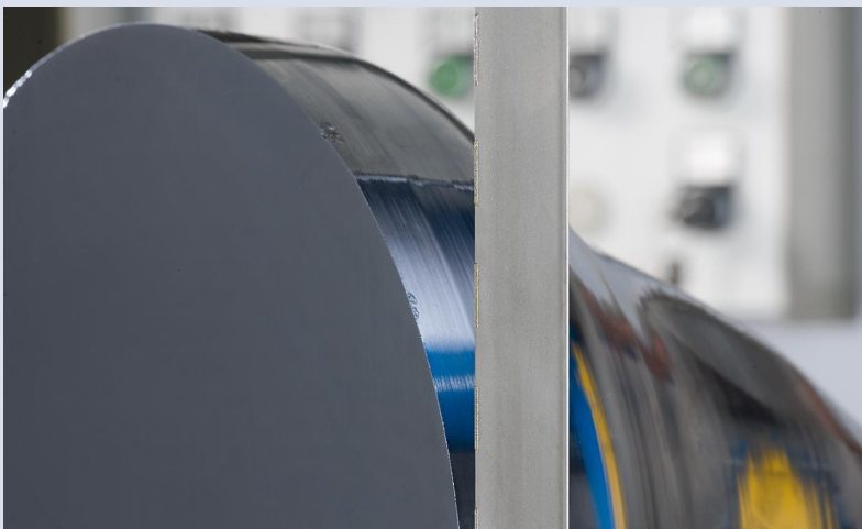
Abbildung 2: Sägen von Silizium mit segmentierter Diamantbelegung
