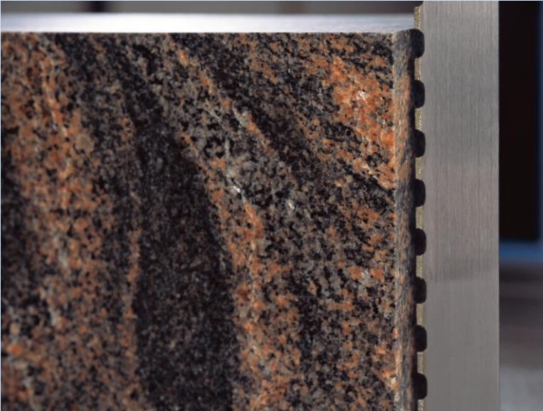
Abbildung 3: Sägen von Naturstein mit unterbrochener Diamantbelegung
