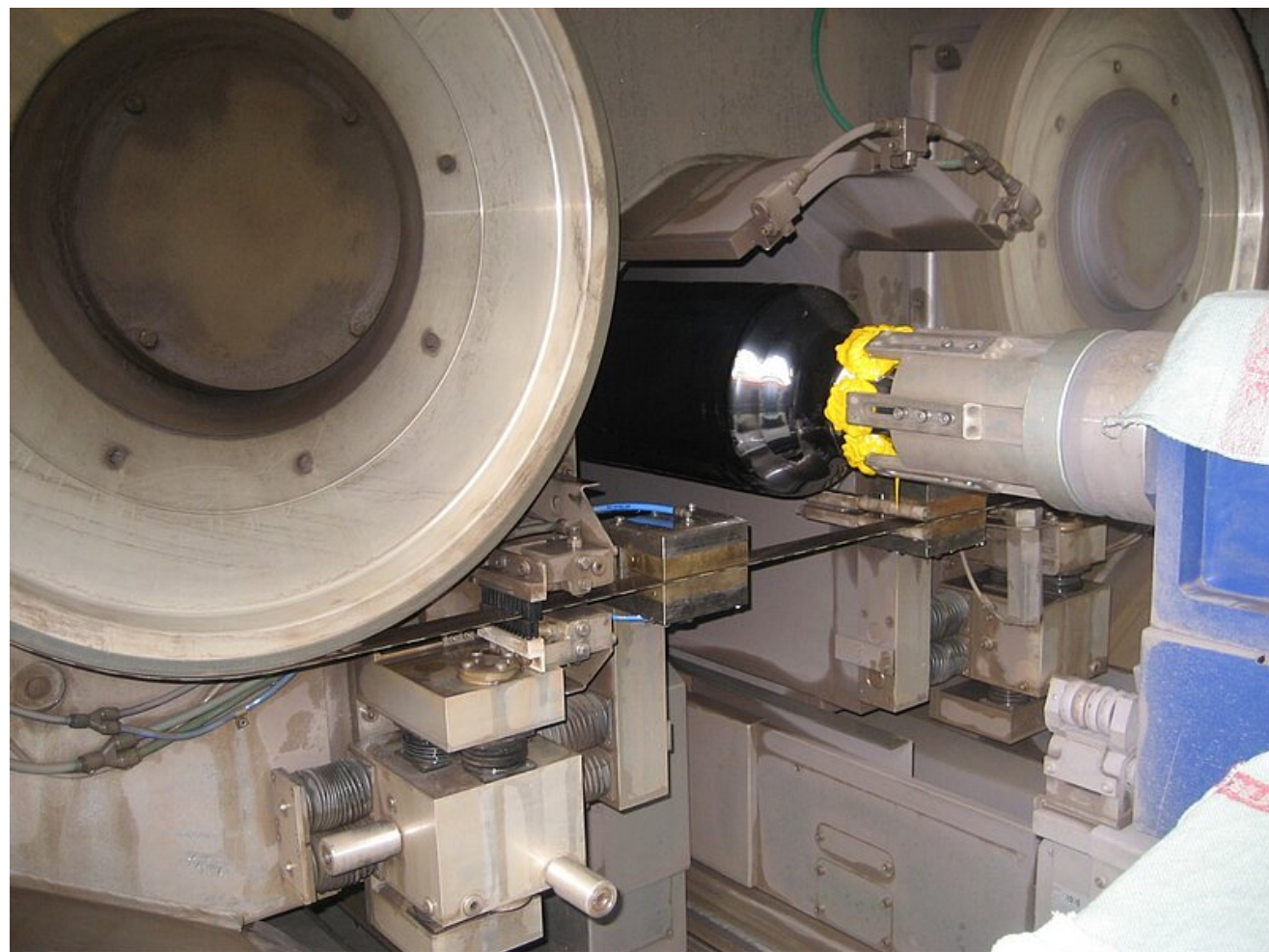
Sägen von monokristallinem Silizium mit DIAGRIT S und segmentierter Diamantbelegung
