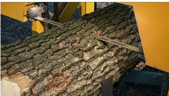
*Illustration 3 : efficace, durable et robuste, la lame de scie bimétallique GENERO<sup>®</sup> est adaptée aux défis les plus divers du sciage du bois. Source : WIKUS-Sägenfabrik*
