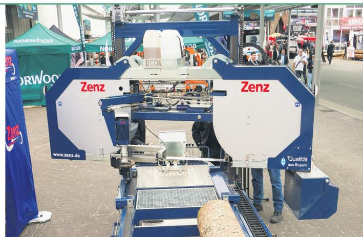
Die Breitbandsäge Ecoline trägt den für Zenz charakteristischen schrägen Sägekopf, der für einen weichen Einschnitt sorgt.
