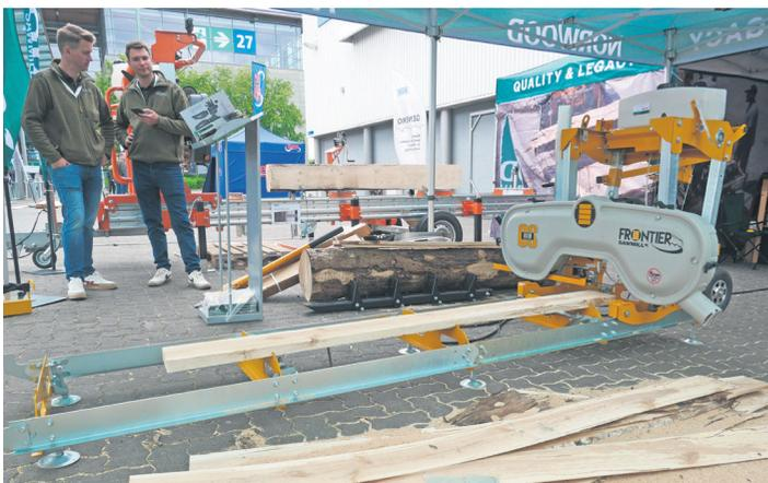
Die kleine Schmalbandsäge Frontier passt in jede Garage und schafft Stämme bis 45 cm Durchmesser.
