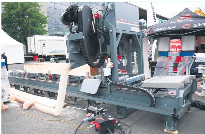
Durch ein breiteres Sägeblatt und weitere Anpassungen wurde die Schnittgeschwindigkeit dieser Profisäge von Pilous deutlich erhöht.
