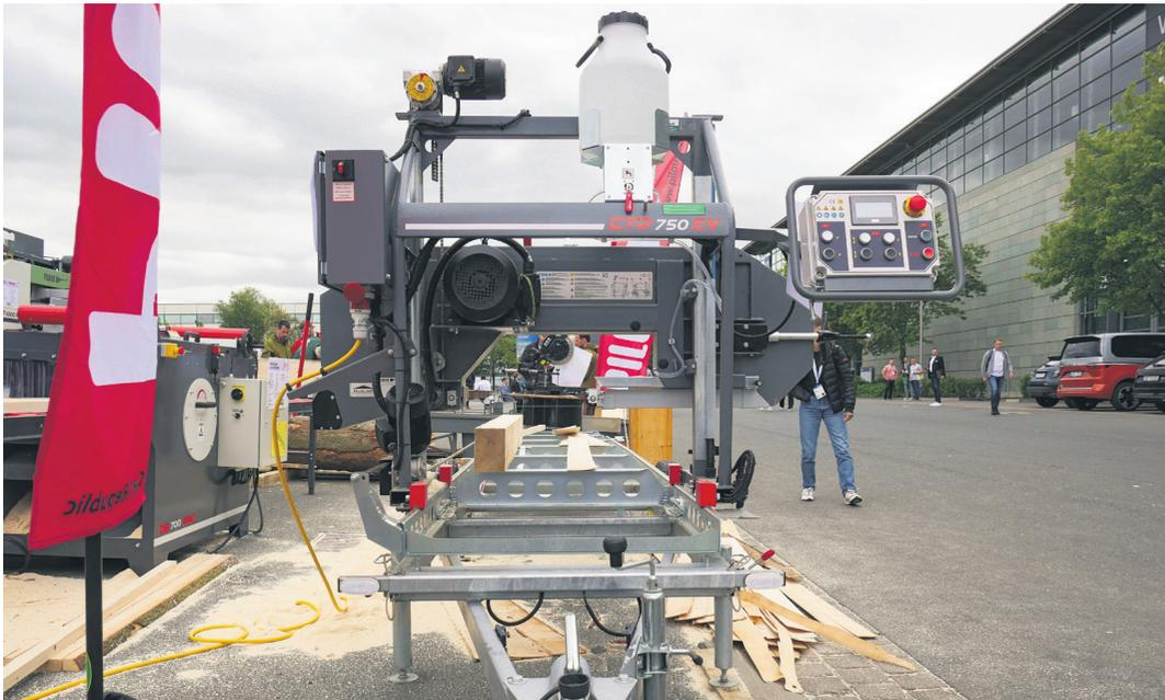
Das Kleinsägewerk CTR750 auf einem Fahrgestell kann Stammdurchmesser bis 75 cm schneiden.
